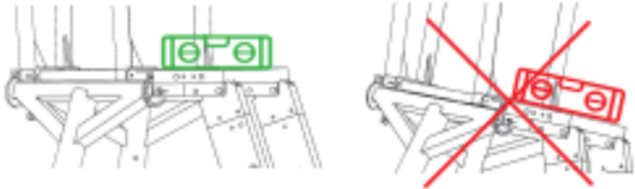
Figura 30. Nivelación correcta de la plataforma.
